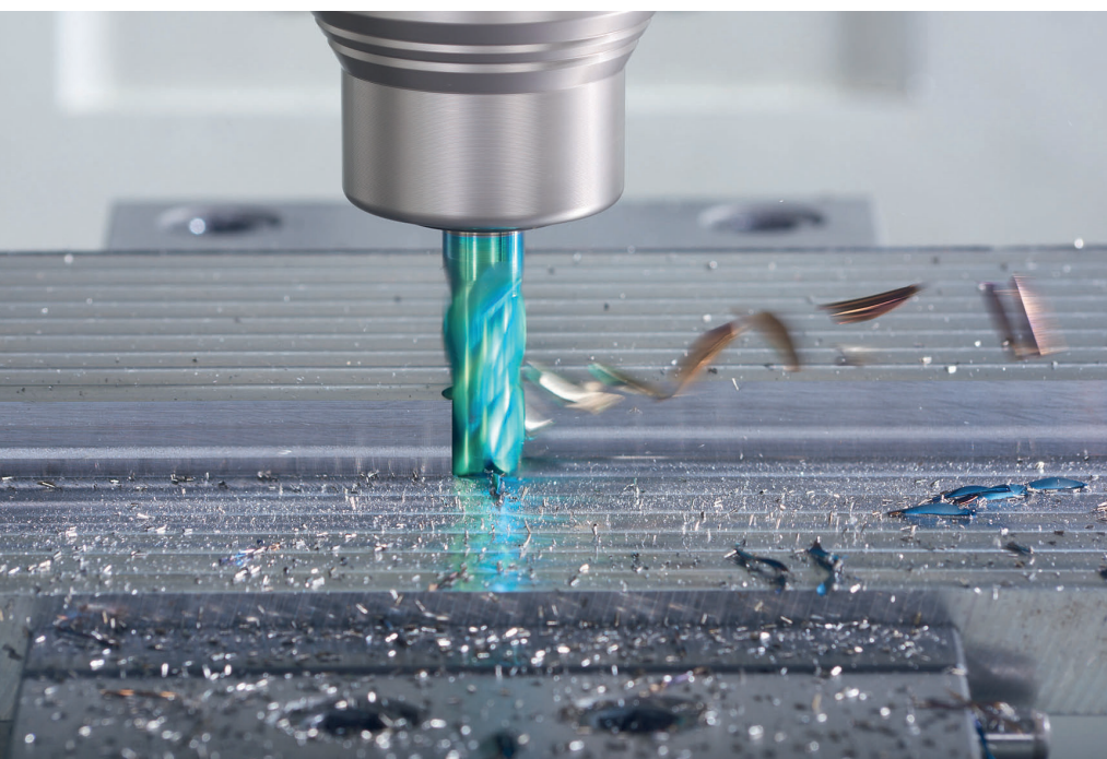
1 In ausführlichen Labortests stellten Beschichtungen der Reihe Baliq Unique unter anderem beim Fräsen von Edelstahl ihre gute Performance unter Beweis © Oerlikon Balzers
